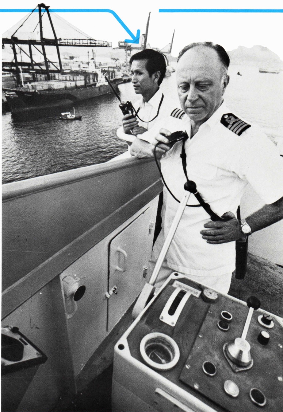
Hong Kong. Lods Ho Hon Sun og kaptajn Johs. M. Rasmussen på M.s. Jutlandia's kommandobro. I forgrunden aggregatet, hvormed man direkte kan manøvrere hovedmaskinen og bovpropellerne.
