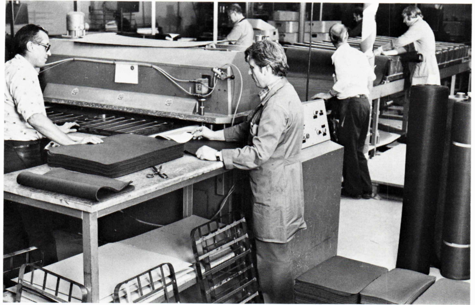
Udstansningen af kuffert-sider foregår på 100-tons stansmaskiner.
