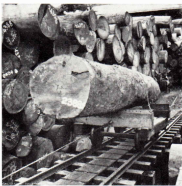
Sekondi. På savmøllen hales stammerne på en blokvogn fra tømmerpladsen op til båndsavene.
