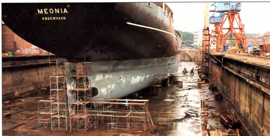
M.s. »Meonia« i tørdok. De lyse felter på skibets udervandsskrog angiver områder, hvor næste lag SPC eksponeres i den forudbestemte slitage- og poleringsproces.
