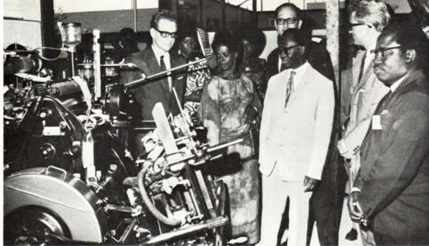
Accra. Premierminister dr. K. A. Busia og hans frue, Naa Morkor Busia, får forklaret brugen af en Heidelberg trykkemaskine (Platen 10 × 15"). Til venstre filialbestyrer Erik Petersen.
