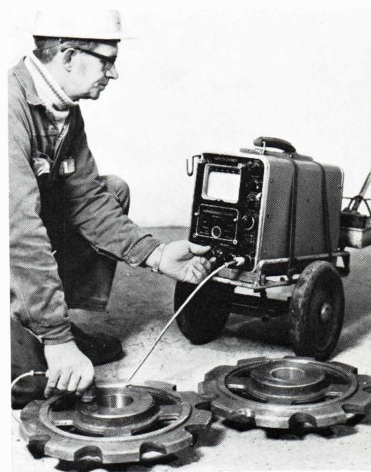
Ultralydprøvning af hjul. Ultra-sonic testing of wheels.
