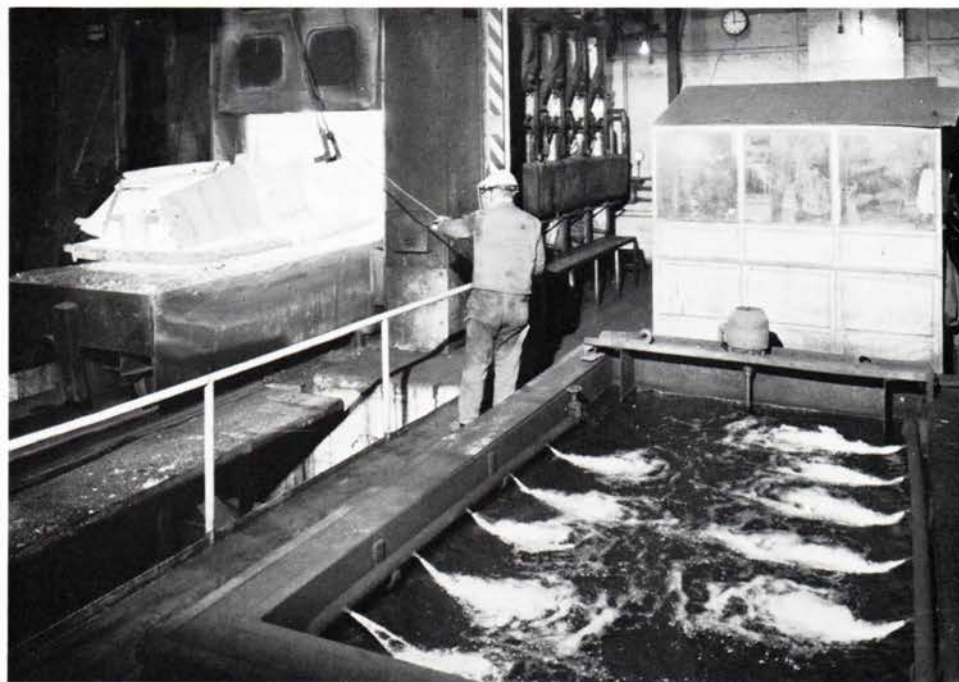
Vandhærdning af 12-14 % manganstål.
