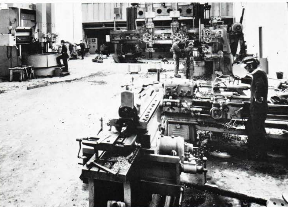
Drejebænk og boremøller til bearbejdning af stål-gods. Turning lathe and boring mills used for machining of steel castings.
