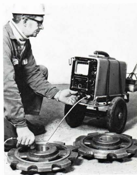
Ultralydprøvning af hjul. Ultra-sonic testing of wheels.
