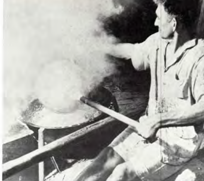
Brasilien. Latex'en drypper ned på en stok, der holdes i rogen over en åben ild, hvorved man får en halv-roget bold.
