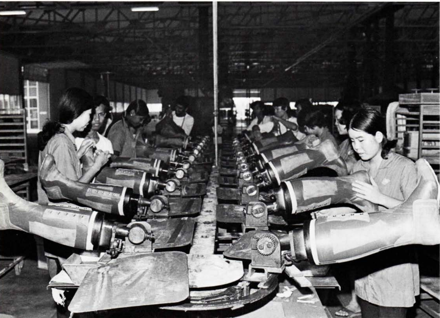
Penang. Støvlerne opbygges på læster. Penang. The boots are built on lasts.
