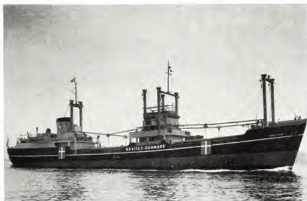
Den gen-gas drevne Navitas, der tilhørte selskabet NAVITAS. The wood gas-driven Navitas that belonged to the company NAVITAS.
