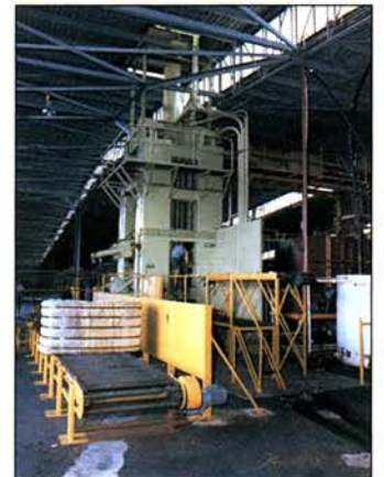
Den imponerende uld-presse i Melbourne, der kan pakke 32.000 tons uld om året.
