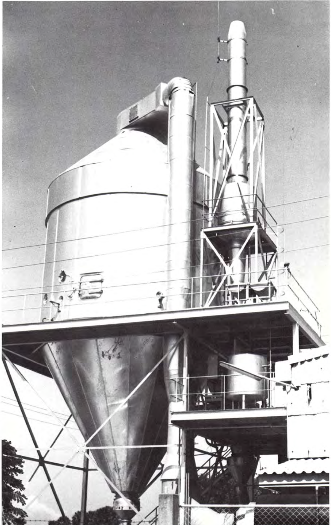
Spraytørrer fra Niro Atomizer Spray dryer from Niro Atomizer.
