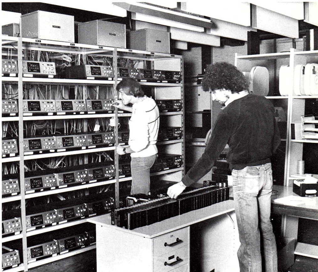
Masterbåndene overspilles til VHS-maskiner på Bellevue Studio. Transfer of master tape to VHS tape recorders at Bellevue Studio.
