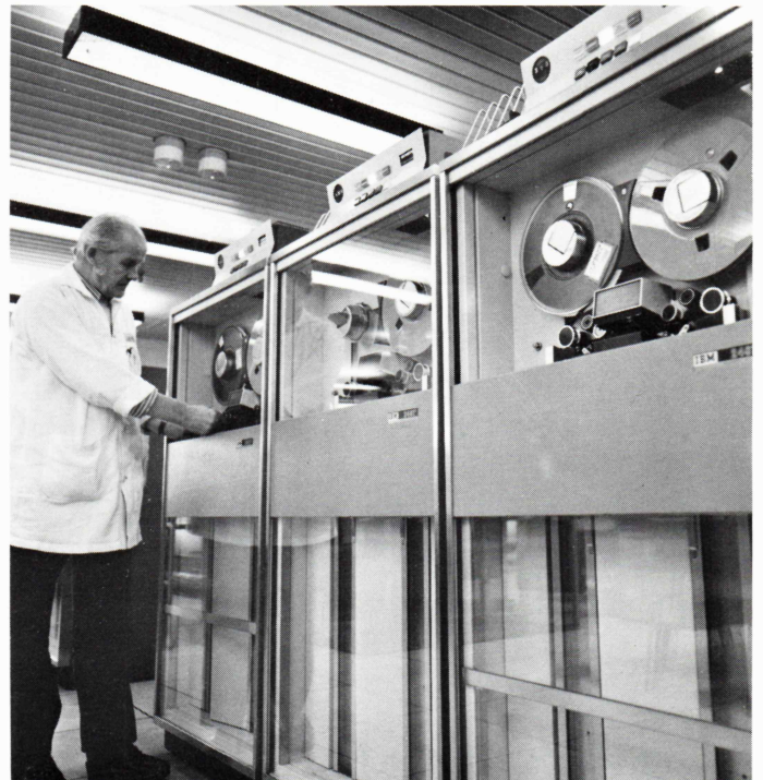
Hr. Svend Jeppesen, ØK Data, foran en af båndstationerne. Mr. Svend Jeppesen, ØK Data, in front of one of the magnetic tape stations.
