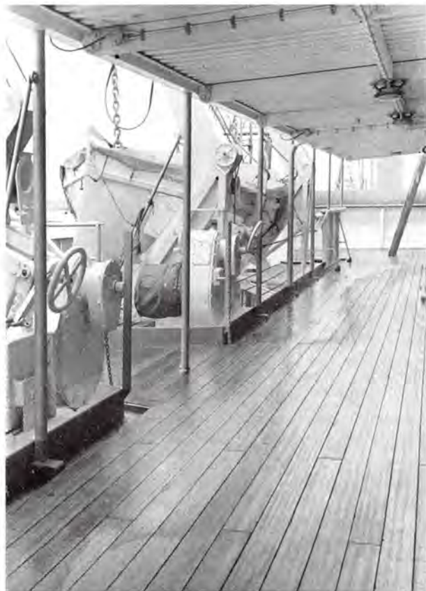
M/S »Simulou«. Første skib i Danmark med et dæk af Borneo White Serayah.
